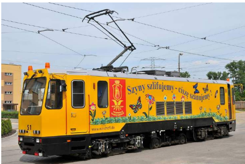
Rys. 37 Szlifierka torowa SF 50 należąca do Tramwajów Warszawskich Sp z o.o. [Zdjęcie Tramwaje Warszawskie Sp. z o.o.]
