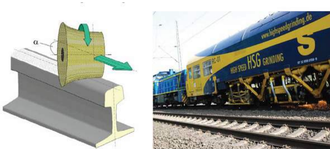
Rys. 36 Szlifowanie szyn metodą HSG - High Speed Grinding [DB Netze: Innovative Maßnahmen zum Lärm- und Erschütterungsschutz am Fahrweg , Schlussbericht, 15.06 2012]
