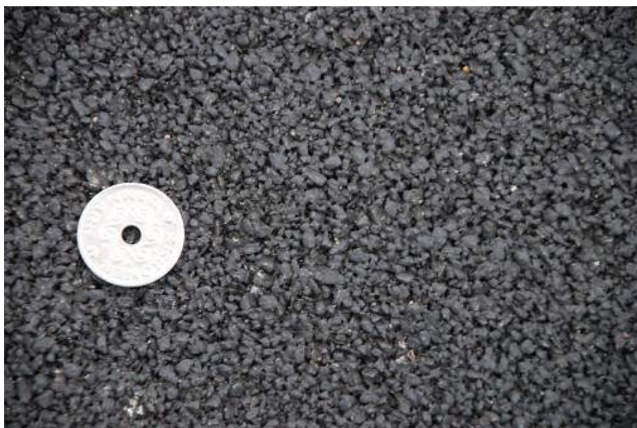
Rys. 26 Nawierzchnia jednowarstwowa [Źródło: DVS-DRI Super Quiet Traffic International search for pavement providing 10 dB noise reduction , Danish Road Institute Report nr 178, 2009]
