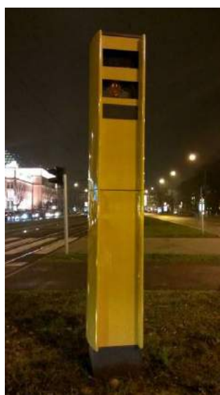
Rys. 23 Urządzenie elektronicznego pomiaru prędkości przy drodze – ograniczenie prędkości ruchu [Zdjęcie J. Lechowska, POŚPH 2013]
